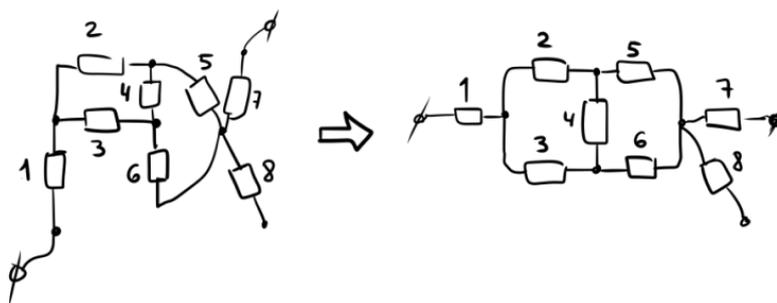
Причем этот мост сбалансирован (т.к.  $R_2/R_3 = R_5/R_6$ ). Значит, по диодам 2 и 5 и диодам 3 и 6 течет одинаковый ток, на диоде 2 и диоде 3 одинаковое напряжение и поэтому между контактами диода 4 нет напряжения и ток по нему не течет, поэтому он не будет гореть, как и диод 8, имеющий не подключенный контакт.
