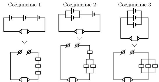
$$\text{Соединение 1: } R_{\text{общ}} = R_{\text{мотор}} + 3r_1 = 60 + 3 \cdot 20 = 120 \text{ Ом} \quad \Rightarrow \quad \mathcal{E}_{\text{общ}} = 3\mathcal{E} \quad \Rightarrow \quad I = \frac{\mathcal{E}}{40}.$$
