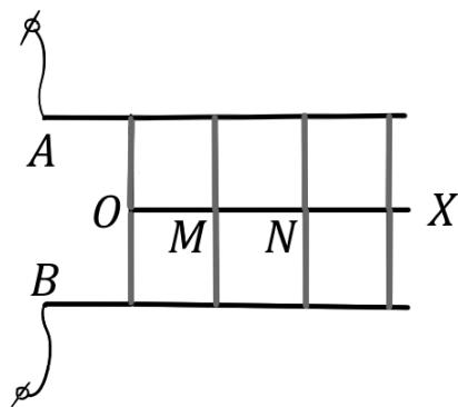
Заметим, что из симметрии потенциалы всех точек линии  $OX$  — одинаковы (и равны среднеарифметическому потенциалов точек  $A$  и  $B$ ). Поэтому разность потенциалов между точками  $O$  и  $N$ ,  $N$  и  $M$  и так далее равна нулю и ток по этим ребрам не идет (то есть, их можно удалить). Получаем схему:
