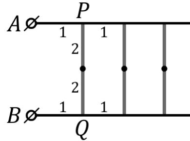
Пусть сопротивление между точками  $A$  и  $B$   $R_{AB} = R$ ; но тогда участок справа от  $PQ$  повторяет всю схему, то есть его сопротивление тоже равно  $R$ . Получается:
